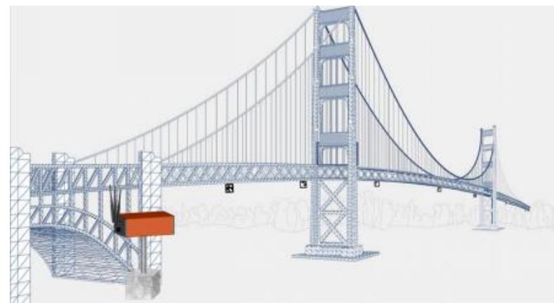
桥墩沉降+桥梁挠度
