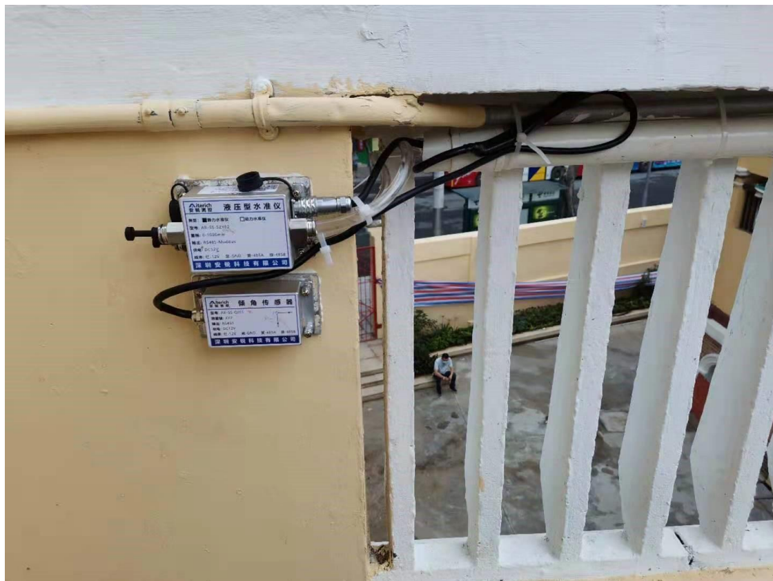
升级前：同一个测点需要安装两台设备
